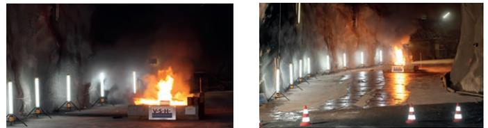
**Bild 2: Thermische Brandeffekte eines Lithium-Ionen-Batteriemoduls (1/8 einer ganzen Batterie)**
