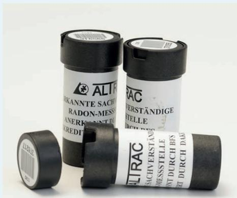
Passive Radon-Dosimeter zur Ermittlung der durchschnittlichen Radonexposition.
