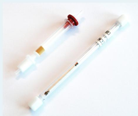
Supports : cartouche DNPH dotée d'un piège à ozone pour la mesure d'aldéhydes/de cétones et tubes TENAX TA pour la définition des COV.
