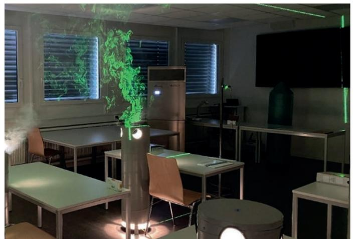
**Bild 1: Untersuchung der Wirkung eines Luftreinigungsgerätes in einem Schulzimmer mittels Aerosolvisualisierung, Einsatz von «Dummies» (Heizylinder) zur Wärmelastsimulation (Quelle: Hochschule Luzern)**
